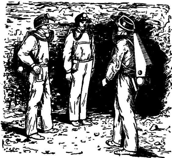
Рис. 30. Спасательный отряд в коях, снабженный стальными цилиндрами с кислородом. Цилиндры укреплены за спиной. Кислород из цилиндра поступает в резиновый мешок, находящийся в предохранительной коробке, а оттуда по трубе — к полумаске, надетой на лицо.
