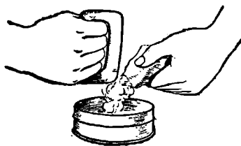
Рис. 63. Высекание огня при помощи кремня и огнива. От огнива отскакивают мельчайшие частички железа, накаливающиеся от удара и дающие искры. В коробке находится трут, который загорается от искр.
